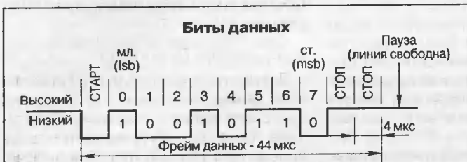
Рис. 4. Структура данных для шины DMX-512
